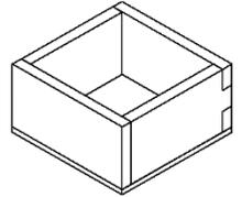
Entwerfe ein Holzkästchen mit quadratischer Grundfläche von 120 mm x 120 mm. Dir steht eine Holzleiste mit den Maßen 500 x 60 x 10 zur Verfügung. Als Eckverbindung an mind. zwei Ecken wählst du eine Fingerverzinkung (3er- oder 5er-Teilung). Als Bodenplatte steht dir eine 5 mm starke Sperrholzplatte zur Verfügung, welche mit dem Holzkästchenrahmen stumpf verleimt wird.
